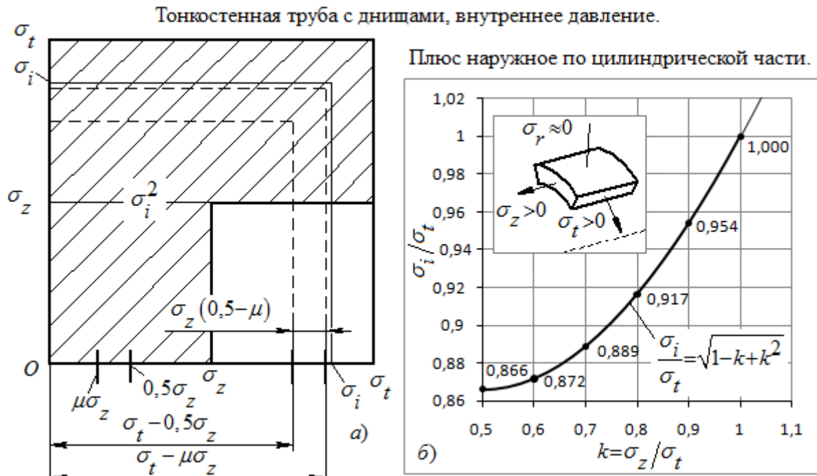
Рис. 3. Интерпретация напряжений для тонкостенной трубы с днищами нагруженной внутренним давлением:
