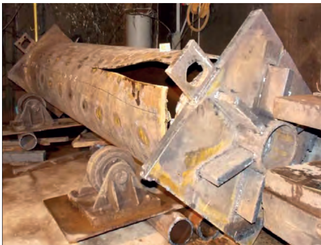
Рис. 4. Загальний вигляд місця руйнування контрольного зразка труби після гідралічного навантаження тиском 13,25 МПа
