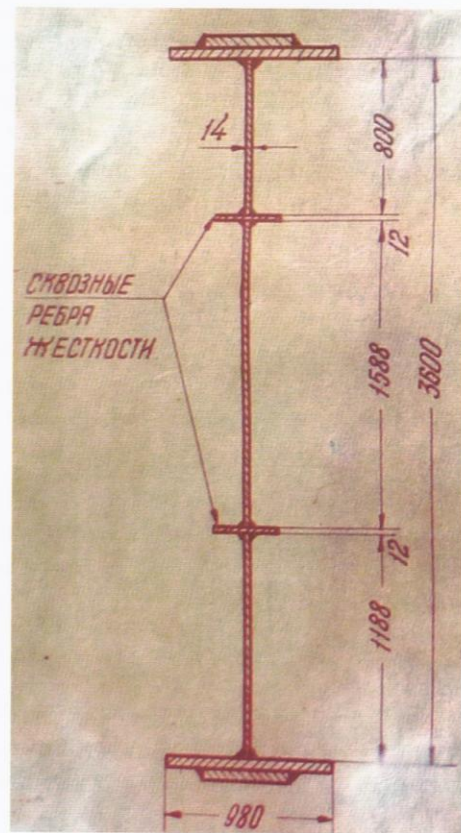
Рис. 4. Поперечний переріз ферми головних поздовжніх балок 4- та 5-прогонових споруд моста
