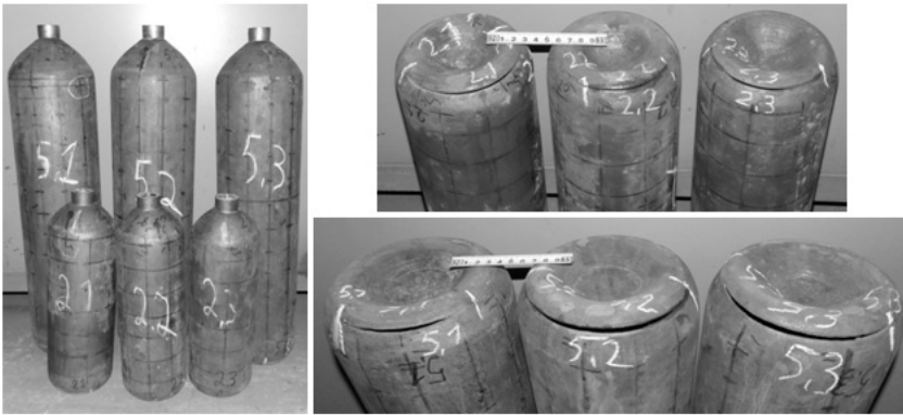
Рис. 3. Фото зруйнованих балонів після циклічних гідравлічних випробувань у вихідному стані та після руйнування.
