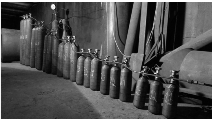
Рис. 1. Зібрані у гірлянду балони для циклічних випробувань пробним тиском.
