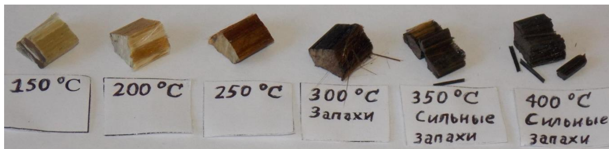
Рис. 15. Элементы петель после получасовых выдержек при различных температурах.
