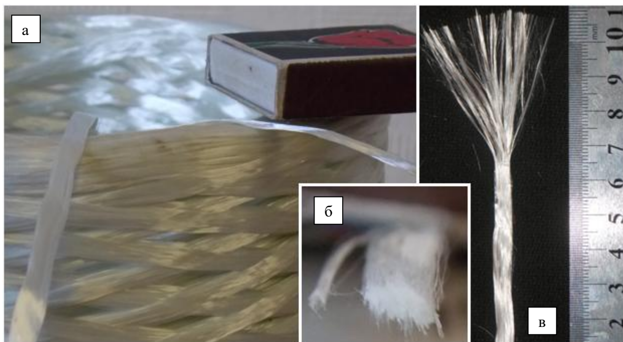
Рис. 1. Ровинг, используемый в качестве армирующего элемента: а - ровинг, уложенный в бобину; б - поперечное сечение ровинга; в - конец ровинга в свободном состоянии.
