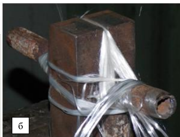
Рис. 16. Укладка ровинга в паз: а - паз, поперечное сечение 19,2×3,1 мм; б - ровинг, уложенный в паз.
