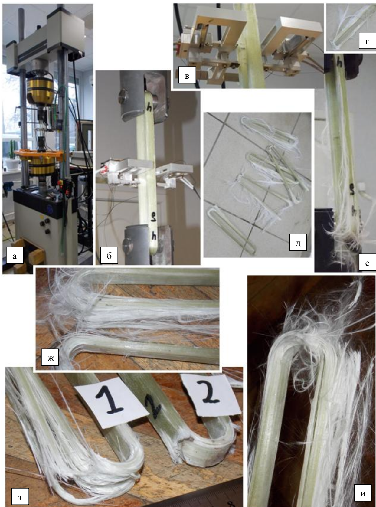
Рис. 4. Испытание на растяжение: а - испытательная машина Instron 8802; б – образец в захватах; в - экстензометр Vi axial 2620-614; г, д, е, ж, з, и - особенности разрушения петель.
